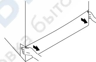
**ℹ** Чтобы снять крышку фильтра, можно слегка прижать ее каким-либо инструментом с тонким пластиковым наконечником, вставив его в щель над крышкой. Не используйте для открывания крышки инструменты с металлическими наконечниками.
